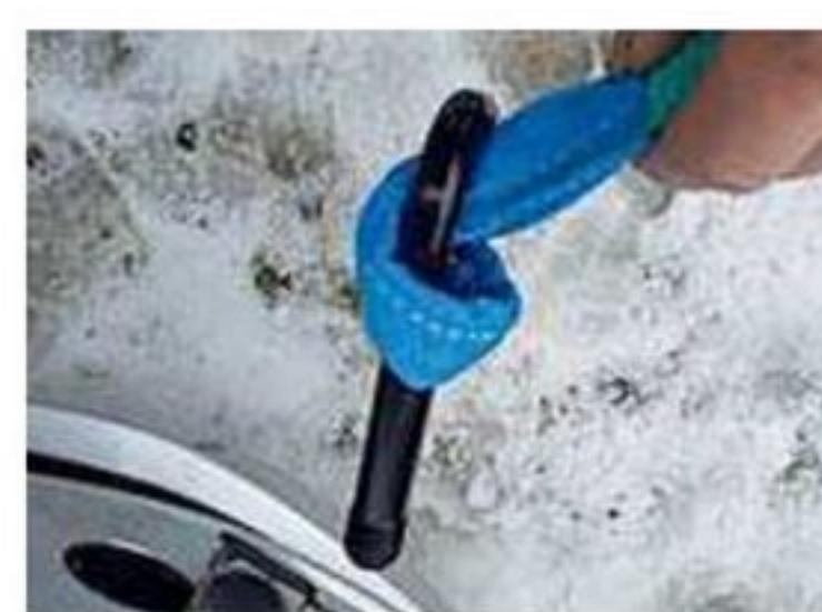
Продеваем петлю троса в отверстие проушки, а затем вворачиваем её. Только надо проследить, чтобы трос не перекрутился.
